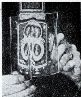
Riscaldamento, curvatura di una lastra di plexiglass e sua applicazione dinanzi all'obbiettivo di una Rolleyflex.
