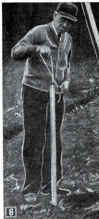
Prova per il controllo della presenza dell'acqua nello strato raggiunto dalla punta: consiste nel calare un lungo filo a piombo nel tubo, fino a che il peso di esso non raggiunga il fondo.
