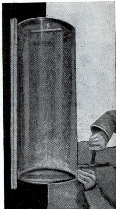
Curvare cautamente il rettangolo di plastica e poi fissarlo con mezzicapi alle costole laterali del pannello posteriore. E' consigliabile fare i fori nella plastica con un trapanino, prima di piantare i chiodini.
